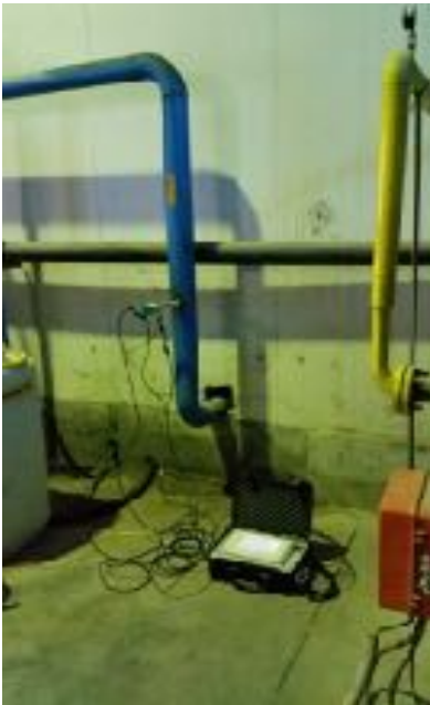
Debi (termal), basınç ve çığlenme noktası ölçümleri
